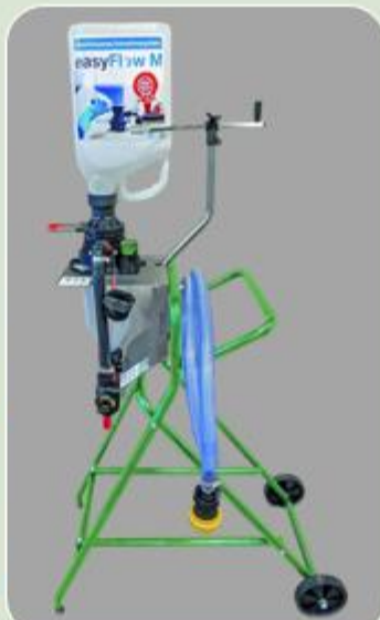
STF ou système de transfert fermé
