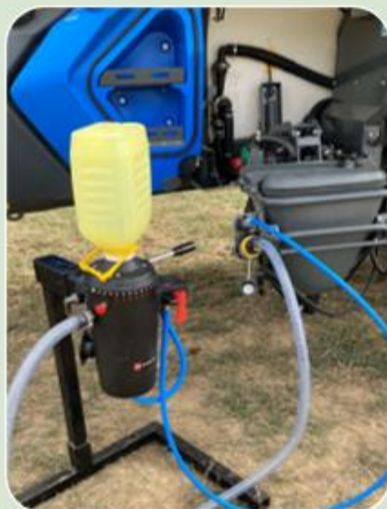
STF ou système de transfert fermé
